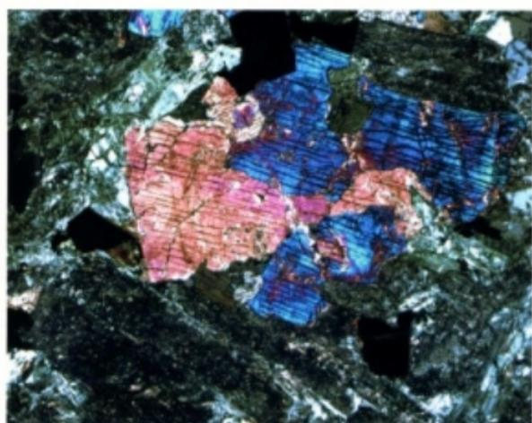
Диагностика образца габбро производилась в лабораториях института по общепринятым методикам визуально и на специальных приборах. Из спила образца изготовлен прозрачный петрографический шлиф (пластина толщиной 0.03 – 0.05 мм) для исследования под микроскопом строения и минерального состава камня.
